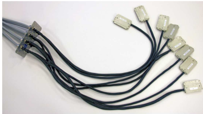
Figure 5 : 8 connecteurs « signal plugs » en bout de câbles
